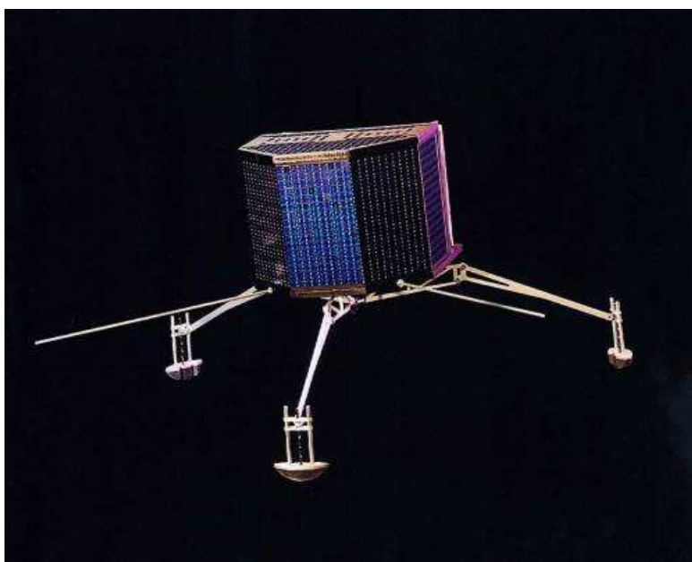
Illustration 7 : L'atterrisseur de la mission Rosetta
